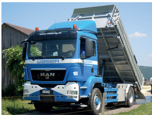
2- ACHS KIPPER Nutzlast: 7,8 to
