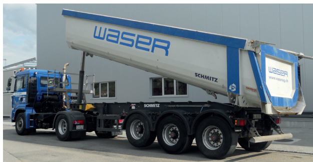
KIPPSATTELZUG Nutzlast: 25,5 to
