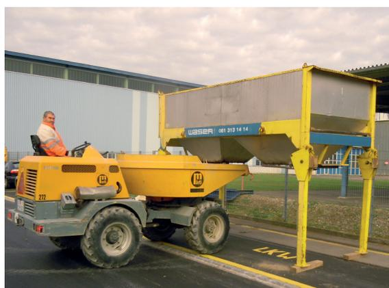
WARMHALTESILO: Unterfahrhöhe 1,6 Meter ab Boden
